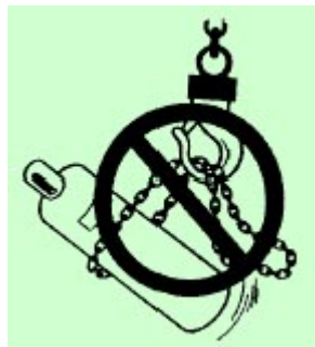
Fig. 5: Indicador de prohibición de utilización de cadenas o cables para transportar botellas de gas
